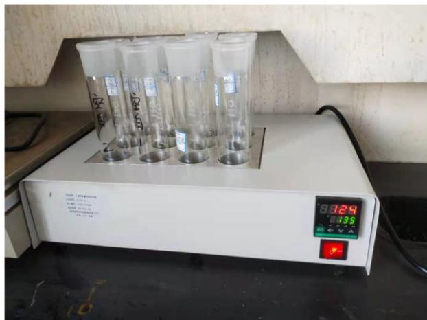
图2 土壤有机碳恒温加热器
