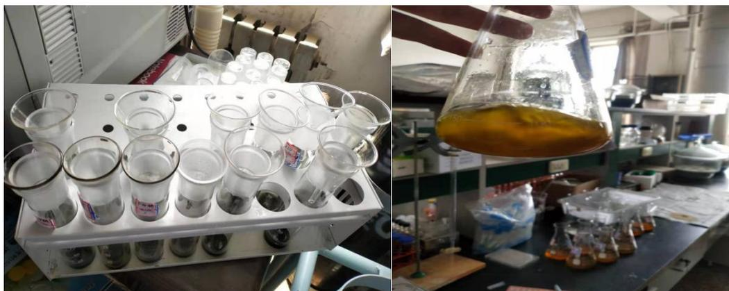
图4 滴定法测土壤有机碳
